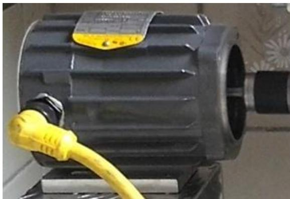
**Figura 8.1** Motor empleado para hacer girar el filtro centrífugo.
