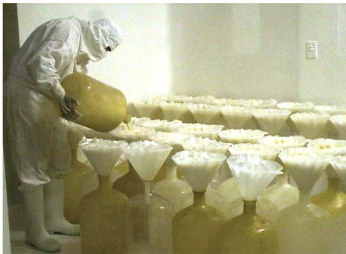
**Figura 1.1** Sistemas de filtrado actual en la preparación de suero antiofídico en el ICP.
