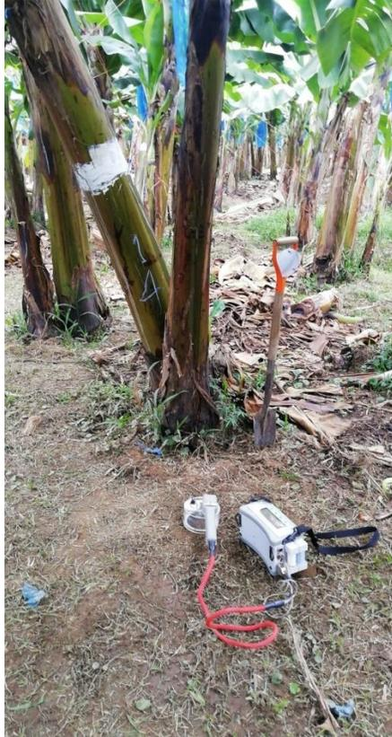
**Figura 8.** Detalle del instrumento Soil Respiration Chamber, adaptado al LCI-SD que se utilizó para medir la respiración del suelo.
