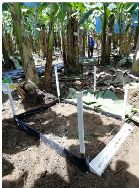
**Figura 4.** Trampas para medir escorrentía y erosión del suelo, en este caso la canoa es el recolector de la trampa.
