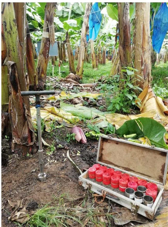
**Figura 3.** Instrumento “Martinelli”, utilizado para extraer los cilindros con las muestras.
