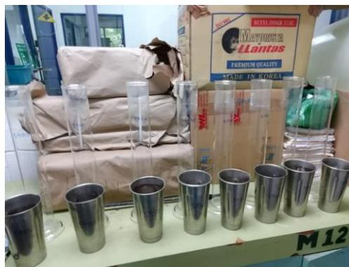
**Figura 5.** Instrumentos utilizados para realizar el método de Bouyoucos.
