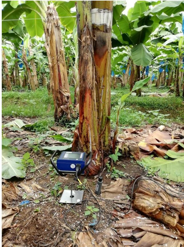
**Figura 2.** Instrumento Penetrologger ML3 versión 6,08 utilizado para medir resistencia a la penetración.
