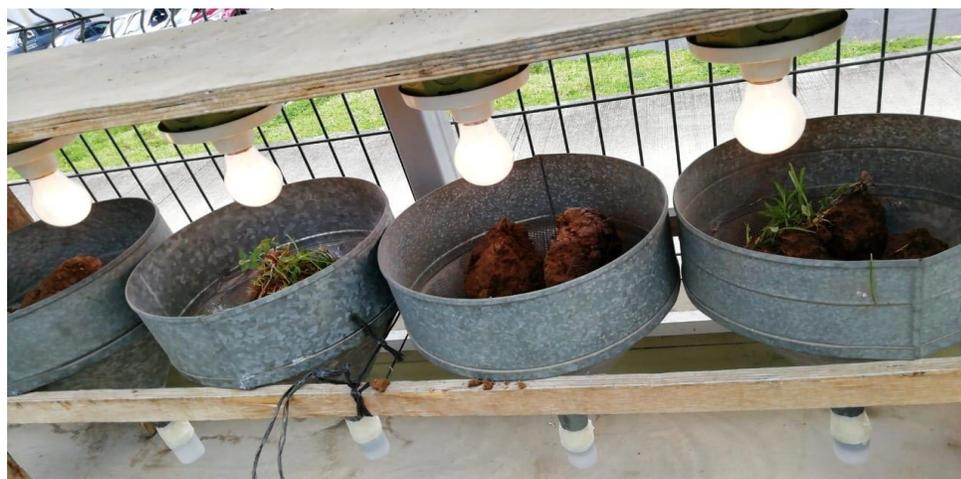
**Figura 9.** Embudos de Berlesse-Tulberg, utilizados para recolectar los microartrópodos de las muestras.
