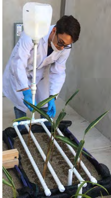
Figura 7. Sistema de PVC para la aplicación del riego con aguas residuales. (Fotografía tomada el 22/03/2019 por el autor)
