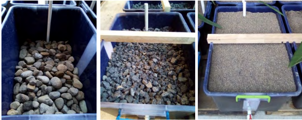
Figura 3. Sustratos que conforman el lecho del humedal artificial, canto rodado (izquierda), piedra volcánica (centro) y granito de río (derecha) (Fotografías tomadas el 08/10/2018 por el autor)
