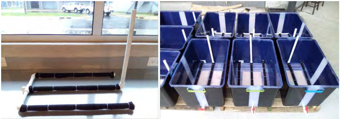
Figura 4. Sistema de drenaje perforado para extracción de muestra. (Fotografías tomadas el 05/10/2018 por el autor)
