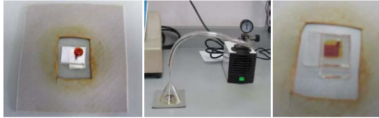
Figura D.3.5. Proceso de llenado del electrolito por medio de diferencias de presión.
