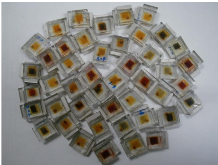
Figura D.3.7. Celdas selladas y con pintura de plata, listas para mediciones.
