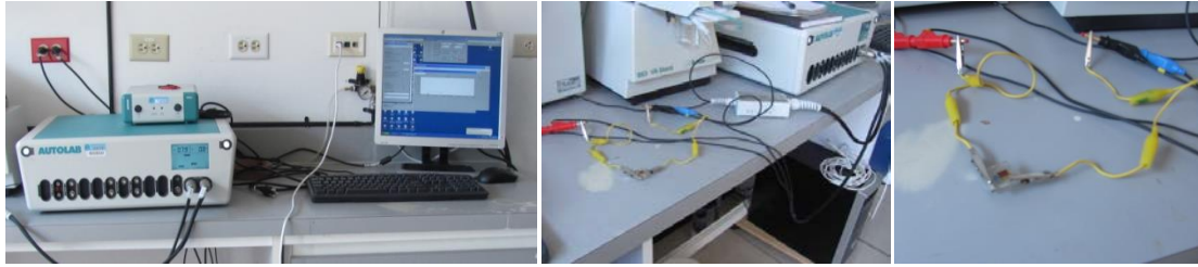
Figura D.4.1. Conexión de las celdas para las mediciones de I-V.
