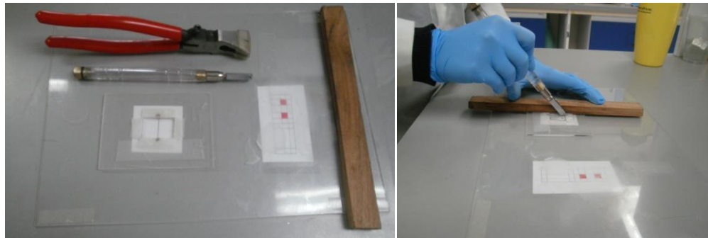
Figura D.1.1. Equipo para realizar el corte en los electrodos de vidrio.
