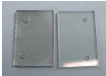
Figura D.2.3. Contraelectrodos, a la izquierda con electrodeposición, a la derecha sin electrodeposición.
