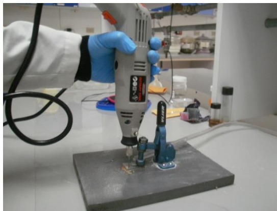
Figura D.2.1. Montaje del equipo para hacer los huecos de los contraelectrodos.
