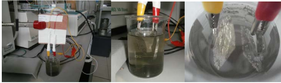
Figura D.2.2. Montaje del equipo para la electrodeposición de Pt en los contraelectrodos.
