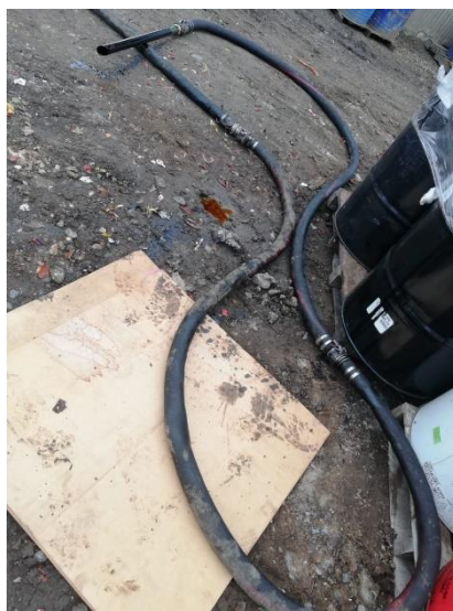
Figura 3.16. Mangueras de succión y descarga de la bomba neumática Wilden.
