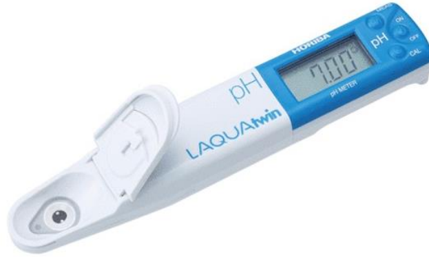
Figura 3.19. Medidor de pH disponible en las bodegas de Wastech.
