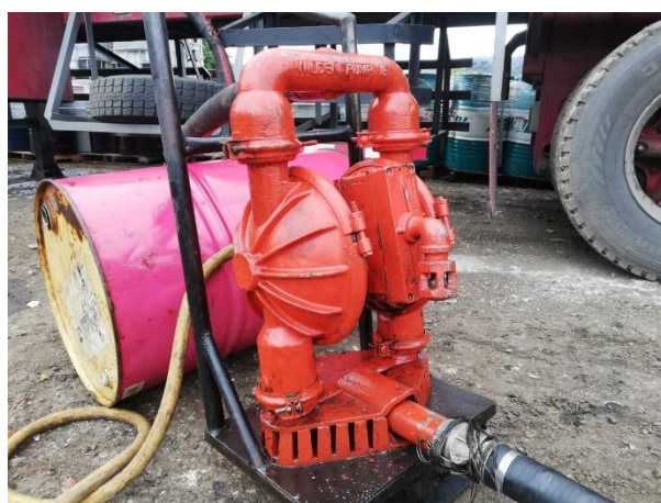
Figura 3.15. Bomba de doble diafragma Modelo Wilden 3" (76 mm).
