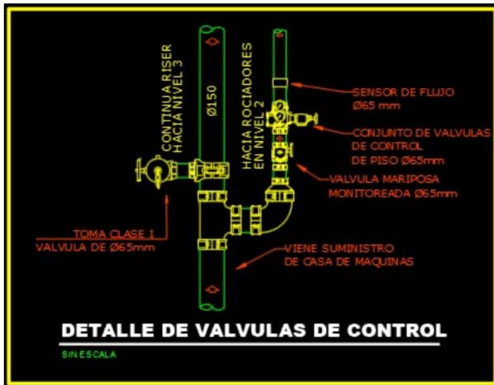
ILUSTRACIÓN XII: DETALLES DE VÁLVULAS DE CONTROL.
