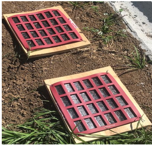
Figura 3.1. Montaje de las muestras de asfalto 1468-13 en la intemperie.
