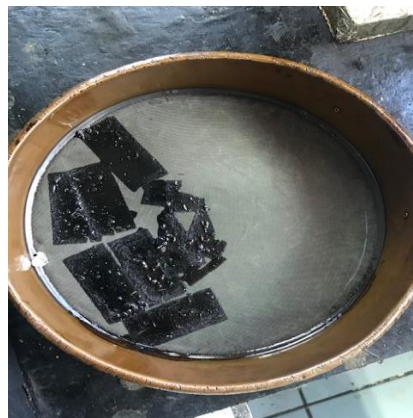
Figura 3.2. Malla de 300 \mu\text{m} para eliminar impurezas del asfalto.
