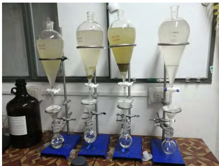
Figura 5. Sistema de extracción empleado para las matrices de agua, utilizando diclorometano como disolvente.
