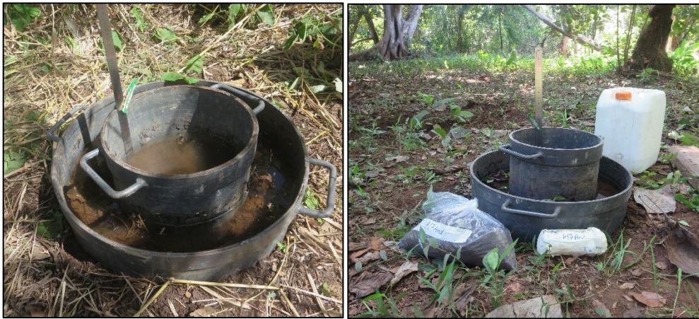
Foto 6: Pruebas de infiltración P15 y P17, en la fotografía de la derecha se observa parte de las muestras que fueron trasladadas para el respectivo análisis de laboratorio.
