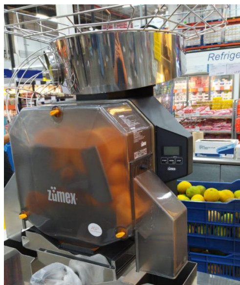
Figura 12. Equipo marca Zumex utilizado para la extracción del jugo de naranja. Modelo Speed S+Plus, Zumex Group S.A.
