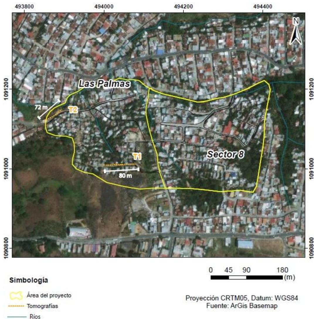
Figura 41. Ubicación perfiles de tomografía eléctrica (Fuente: Elaboración propia).
