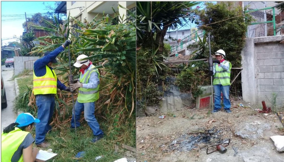
Figura 20. Sondeos de penetración ligera tipo DPL.
