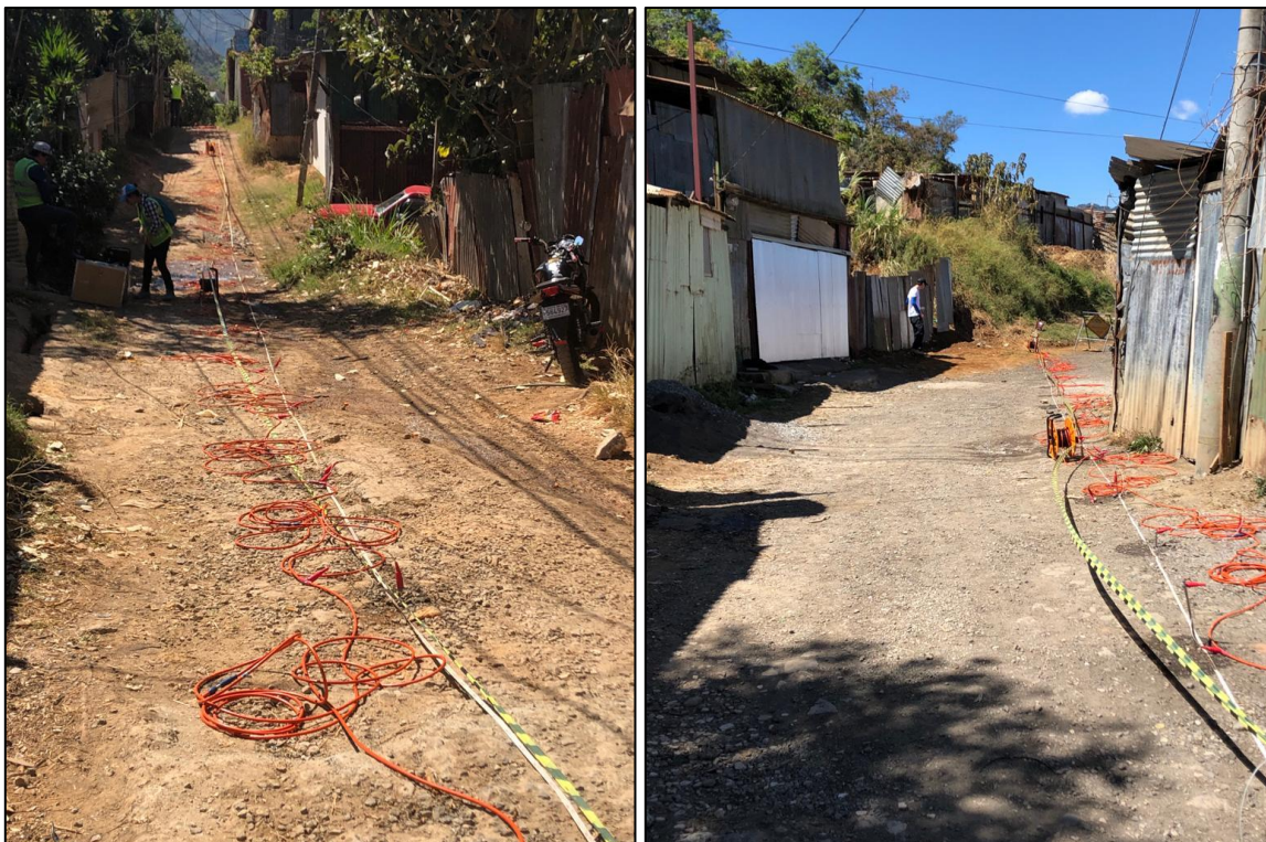
Figura 18. Ensayos tomografía eléctrica.
