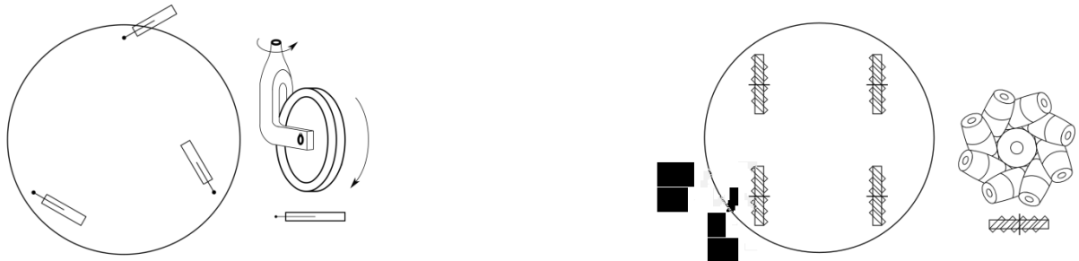
Figura 2.1: Dos ejemplos de bases omnidireccionales: a la izquierda el uso de ruedas giratorias, a la derecha ruedas Mecanum
