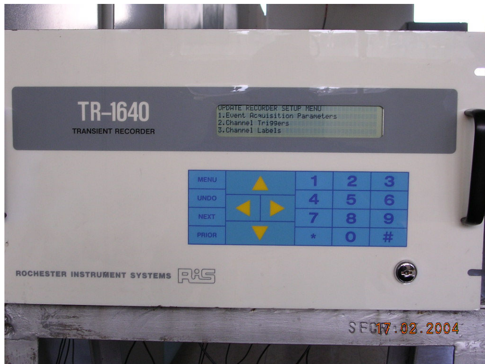
Figura 2.10 Equipo registrador de transitorios
