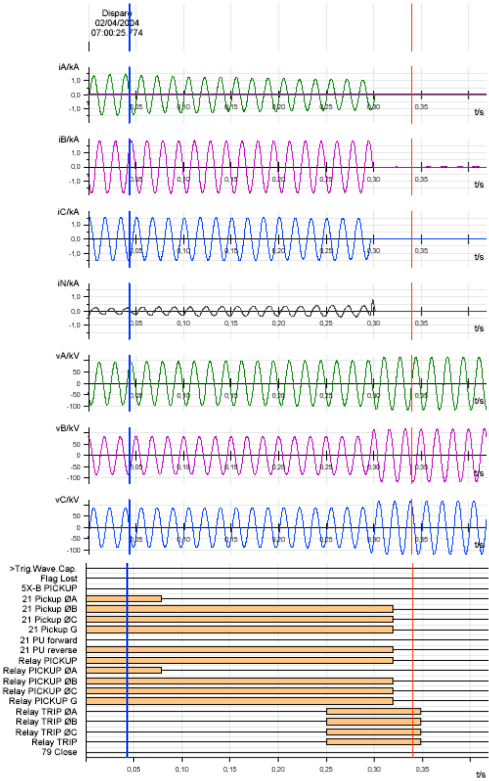
Figura 3.17 Información del relé para el evento #2, Alajuelita-El Este, 6:51 h
