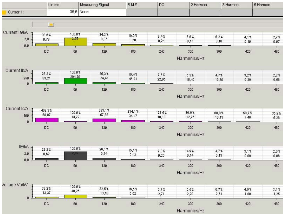
Figura 2.18 Información del relé – armónicas
