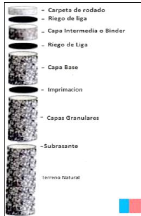
Figura 3. Posibles capas de un pavimento flexible
