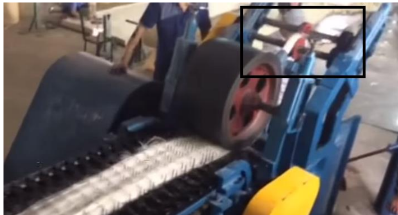
Figura 17 Sistema de extracción de fibra original de la peinadora
