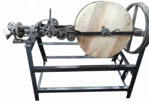
Figura 19 Máquina de encordado y embobinado.
