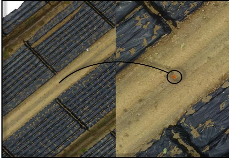
Figura 4. Acercamiento a un punto de control para su identificación y marcaje en Agisoft Photoscan™.
