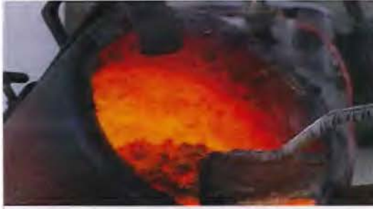
Imagen 31. Bronce fundido en crisol
