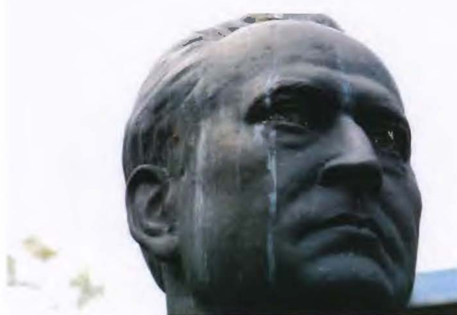
Imagen 63. Enfoque del rostro, agentes y formaciones de cloruros.
