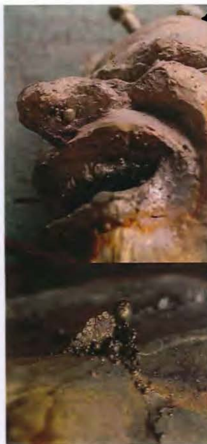
Imagen 34. Burbujas producto del aire retenido
