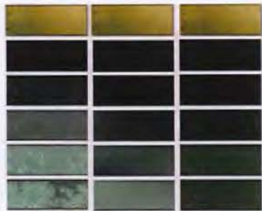
Imagen 12. Aleación de cobre. Proceso de corrosión: izquierda, en medio urbano; centro, en medio rural y a la derecha, en zona costera. Fuente: Ministerio de cultura, juventud y deportes de España, 2011
