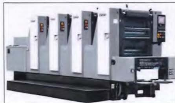
Imagen N° 29: Máquina offset de 4 colores. Recuperado de: http://www.printingmachine.es/1-2-quarto-gh564.html
