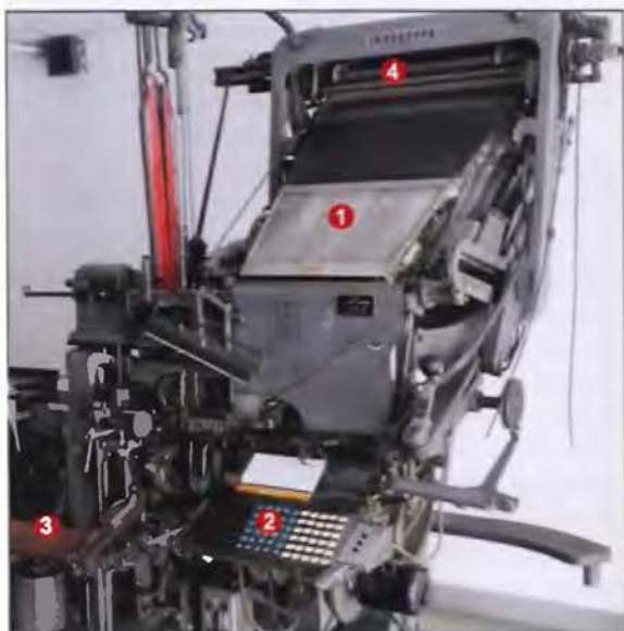
Imágenes N° 27 ▲ y 28 ► (columna adjunta): Máquina de Linotipo. Secciones principales: 1.-El magazín, 2.-El Teclado, 3.-Bandeja de lingotes y 4.-El mecanismo de distribución. Archivo personal.
