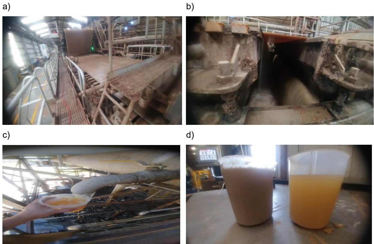
Figura 7.7. Muestreo de las corrientes de alimentación y salida del DAF, a) mesas de formación, b) punto muestreo drenaje mesas de formación, c) punto de muestro agua clarificada en salida del DAF, d) contraste visual agua entrada y salida del DAF (fotografías tomadas en Empaques Santa Ana el 06 de marzo del 2019).
