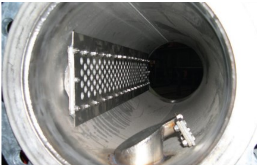
Figura 2.5. Esquema bridado de las membranas formadoras de microburbujas en el ADT (krofta, 2017).
