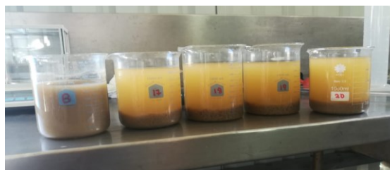
Figura 7.1. Prueba de jarras a) floculación en equipo de jarras, b) alícuota del agua clarificada, c) efecto del exceso de floculante (muestra derecha), d) contraste visual del agua alimentada y clarificada con 20 minutos de reposo.
