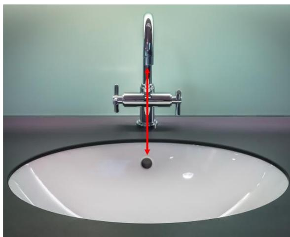
Figura 31. Espacio libre entre la boca del grifo y en nivel de rebose de la pieza sanitaria
