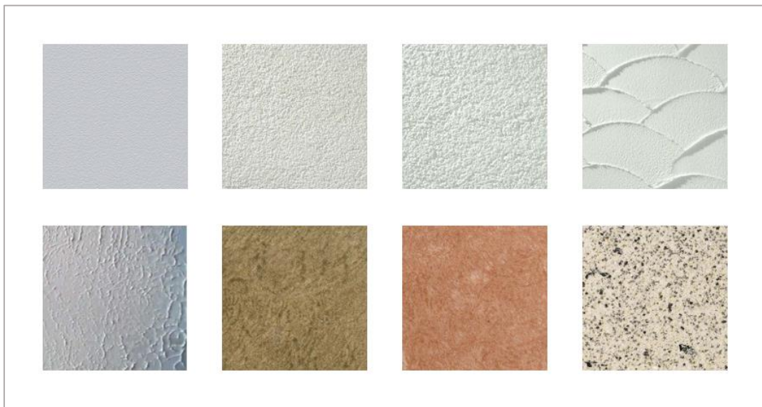
Figura 68. Ejemplos de acabados en paredes de concreto
