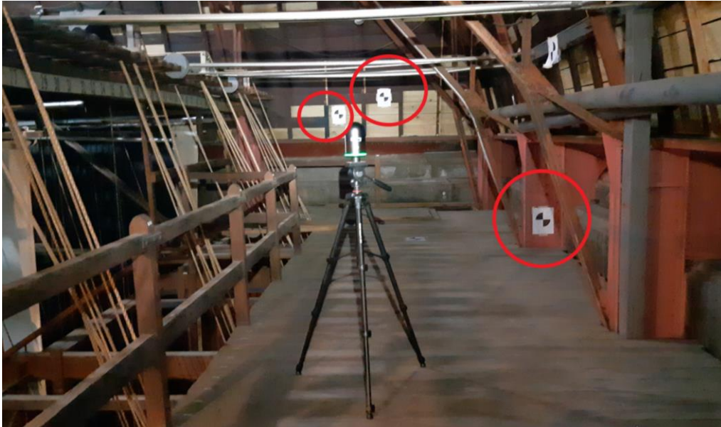
Figura 20. Fotografía de la utilización de targets durante el escaneo en la tramoya Fuente: Murillo, 2020.
