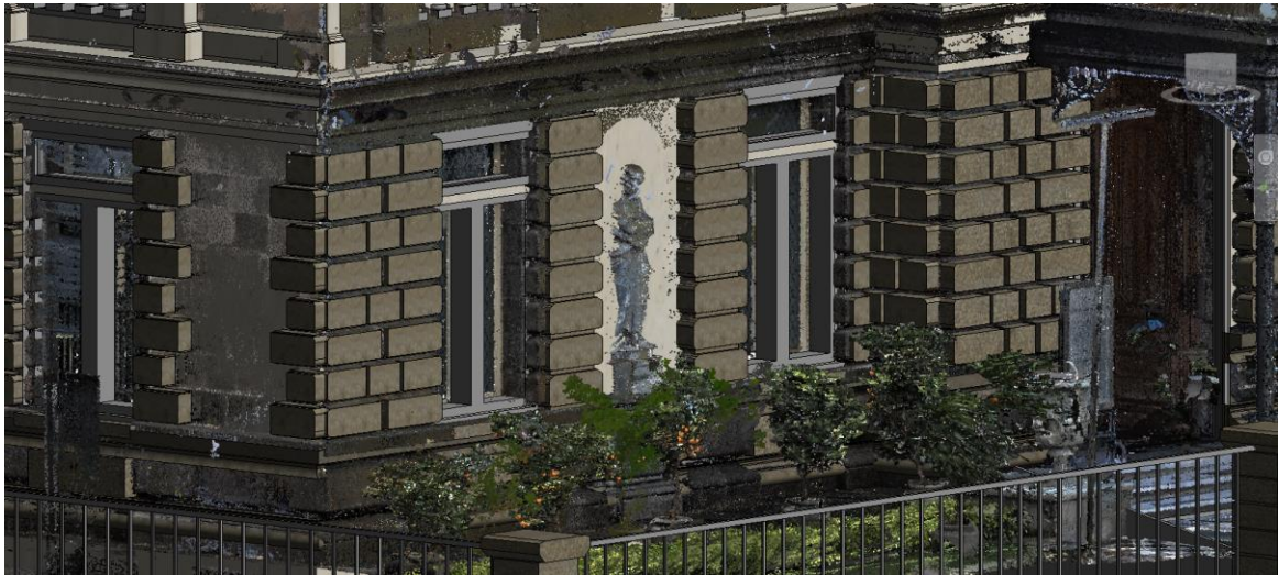
Figura 68. Detalle de almohadillas de arenisca del modelo superpuestos con la nube de puntos
