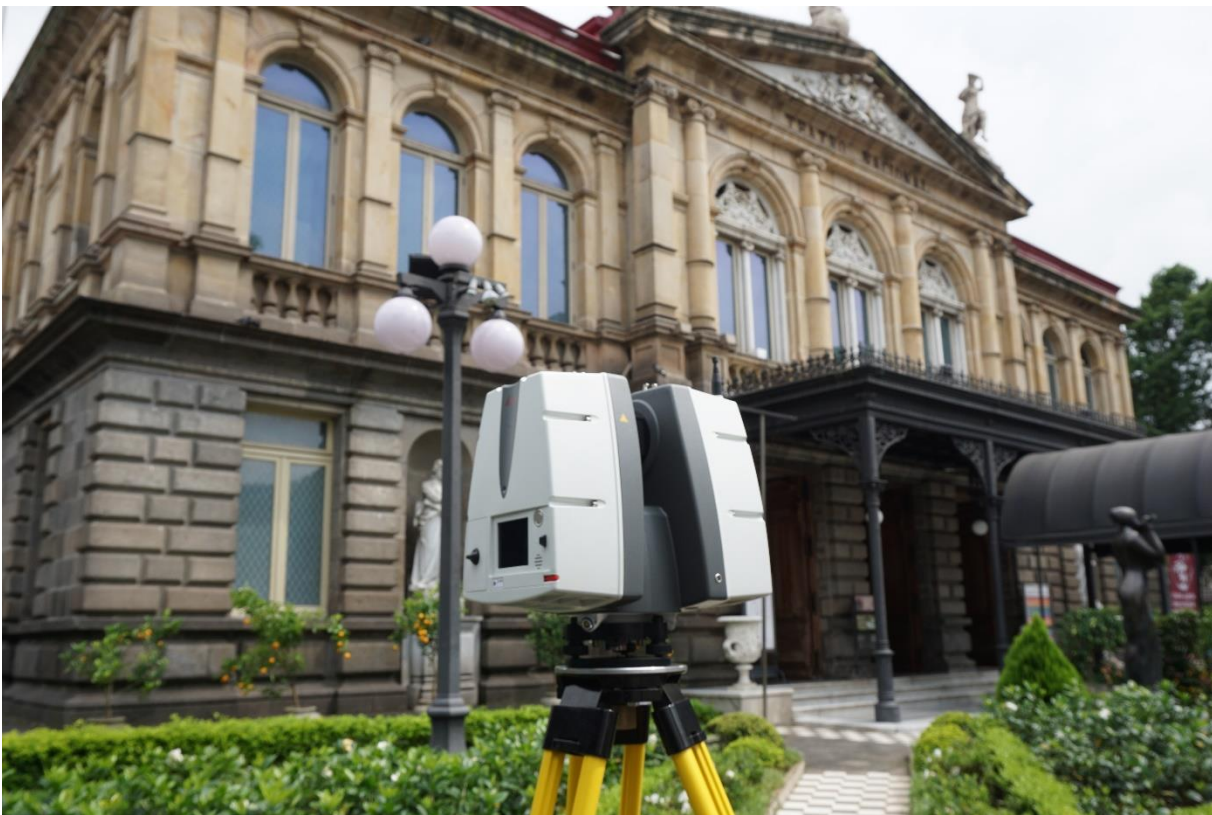
Figura 21. Escáner P40 en la fachada del Teatro Nacional de Costa Rica Fuente: Corrales (2020).
