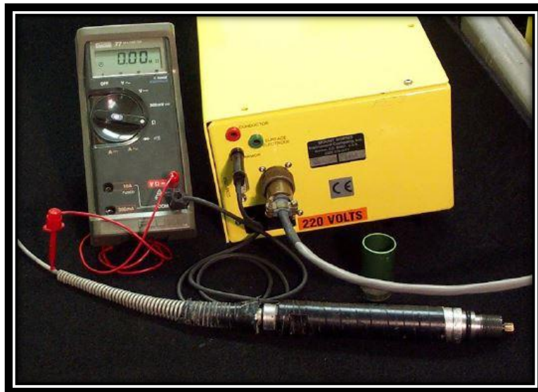
Fig. 24. Forma de colocar los cables medidores para verificar la continuidad del armor. Modificado de Mount Sopris, 2013.
