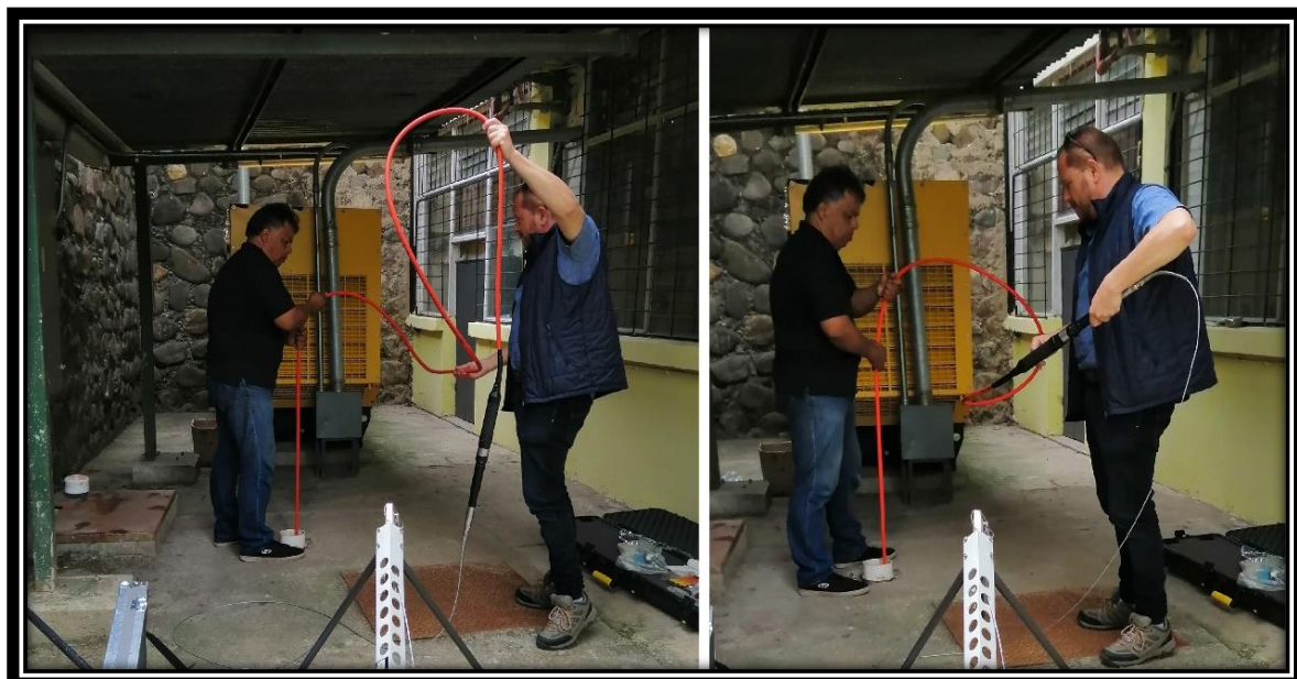
Fig. 33. Se observa la forma correcta para introducir el conjunto puente aislante-sonda.
