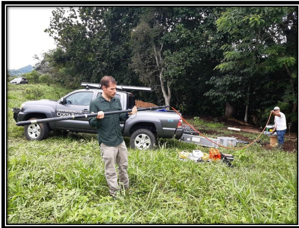
Fig. 56. Instalación de equipo 40 GRP-1000 en la localidad de Atenas. En la fotografía se observa la sonda de medición unida al puente de aislamiento (color naranja) que a su vez es conectado al “cablehead” del “winch”.
