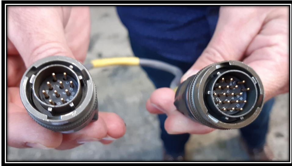
Fig. 22. Conectores del “winch” a la consola “Matrix” y la computadora portátil.
