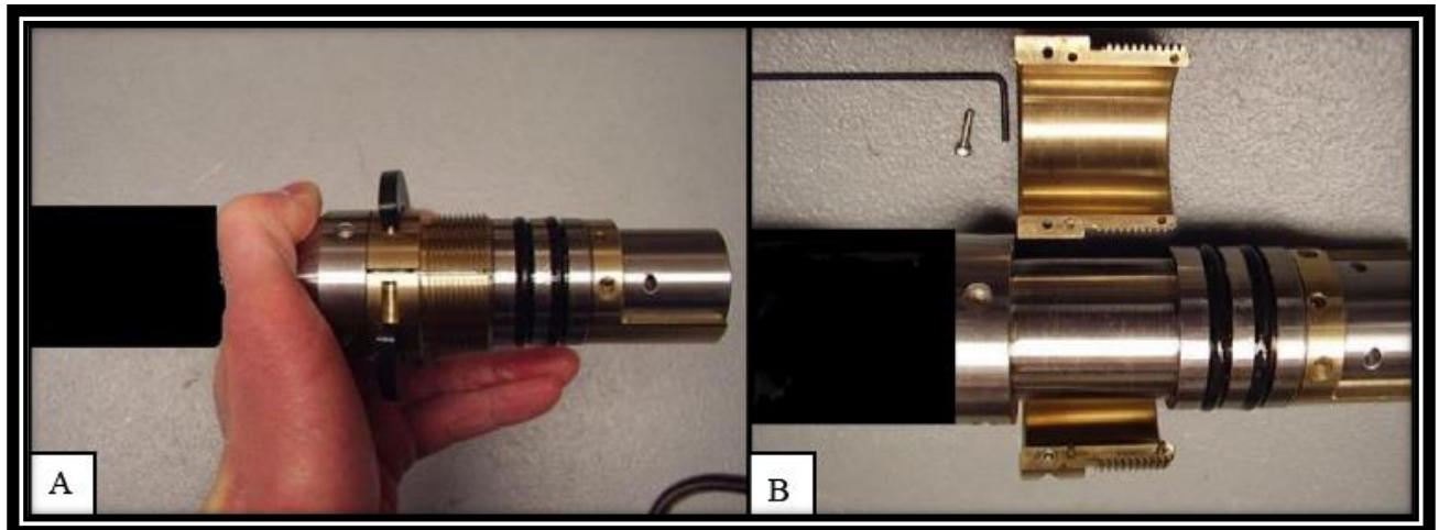
Fig. 10. Desmontaje de la parte superior de la sonda para mantenimiento. Modificado de Advanced Logic Technology, 2013.
