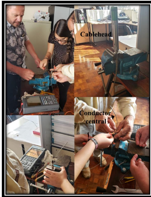
Fig. 77. Se observan varios pasos del procedimiento de montaje/desmontaje del “cablehead”.
