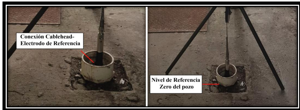
Fig. 34. Forma correcta de colocar el sistema en el nivel de referencia "zero".
