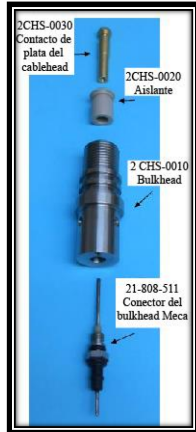
Fig. 22. Partes del bulkhead. Modificado de Mount Sopris, 2013.
