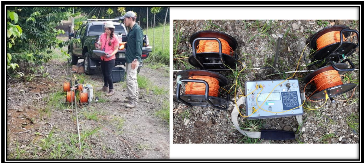
Fig. 61. Ubicación del equipo para la realización del Sondeo Eléctrico Vertical en la zona de Sabana Larga de Atenas.
