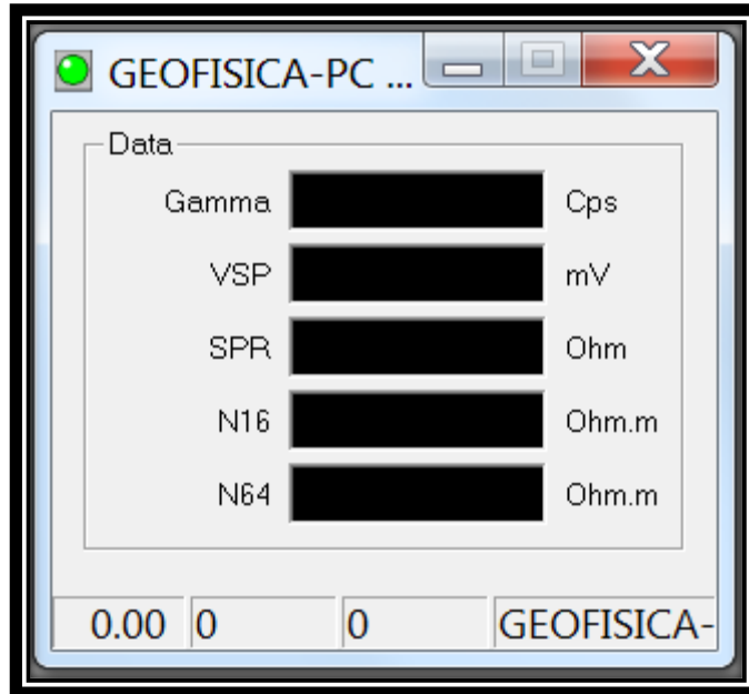
Fig. 51. Cuadro de diálogo con los valores numéricos de los parámetros medidos por la sonda.
