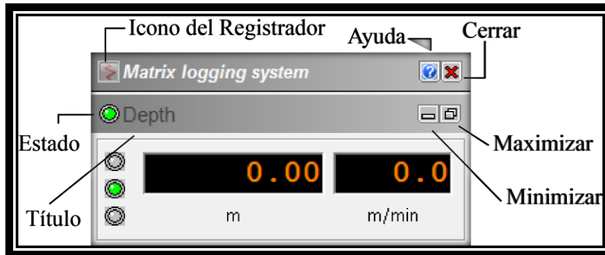
Fig. 38. Partes del panel de profundidad. Modificado de Mount Soprs, sf.
