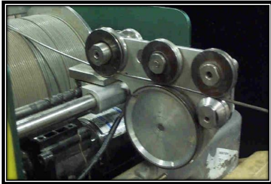
Fig. 14. Posición correcta del cable para realizar mediciones. Modificado de Mount Sopris, 2012
