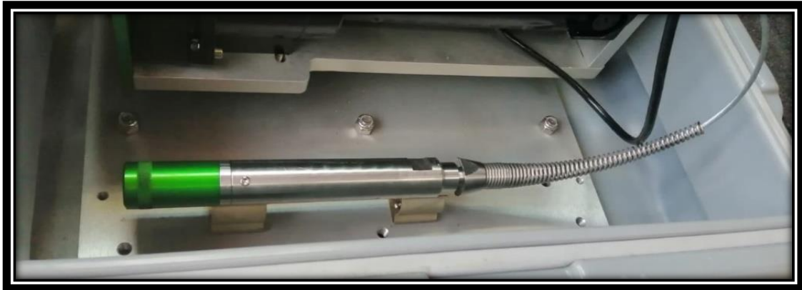
Fig. 16. Se muestra el “cablehead” del” winch”.
