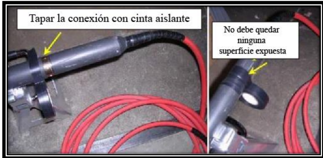
Fig. 9: Conexión del electrodo de referencia o “fish” y la parte superior de la sonda. Modificado de Advanced Logic Tecnología, 2013.
