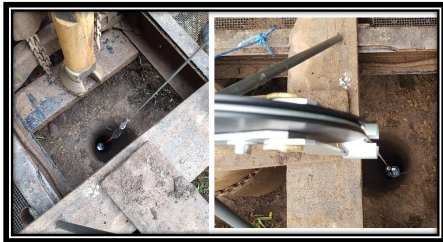
Fig. 58. Forma correcta de colocar el trípode, buscando la verticalidad y el centrado de la sonda en el pozo.
