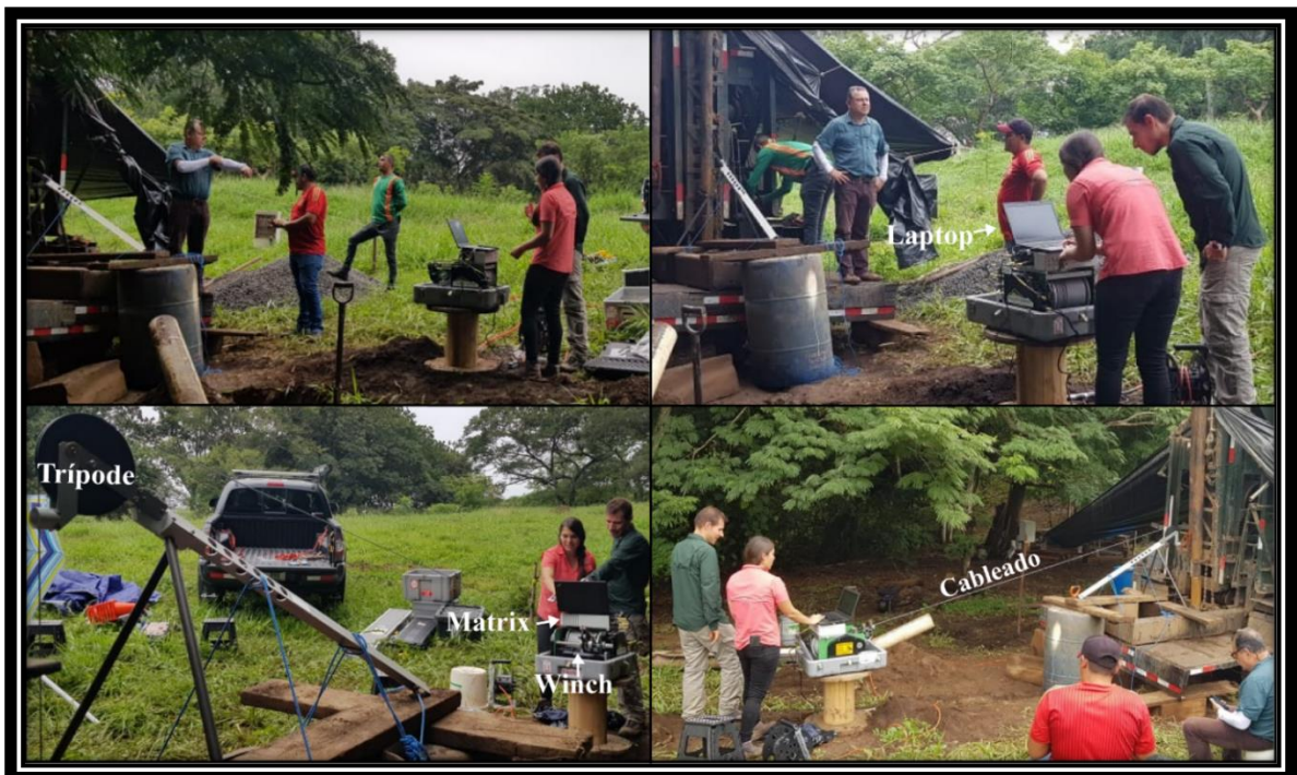
Fig. 59. Ubicación correcta del conjunto “winch-laptop - “Matrix” en línea recta con respecto al trípode. En las diferentes imágenes se muestra cada uno de las partes del equipo.
