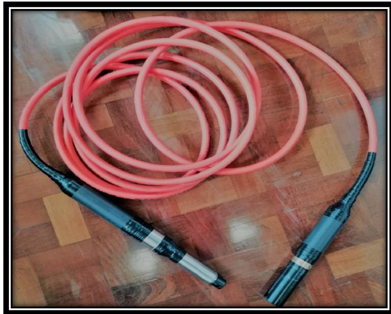
Fig. 10. Puente aislante o de aislamiento.
