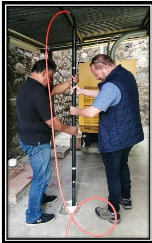
Fig. 32. Se observa la forma correcta para introducir la sonda dentro del pozo.
