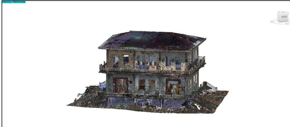
Figura 22. Nube de puntos en Revit
