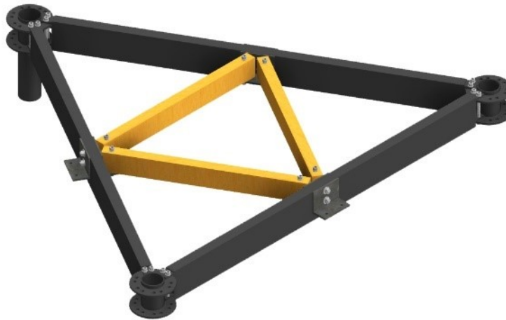
Figura 7.33. Detalle en isométrico de unión triangular base de la estructura de piso. 239
