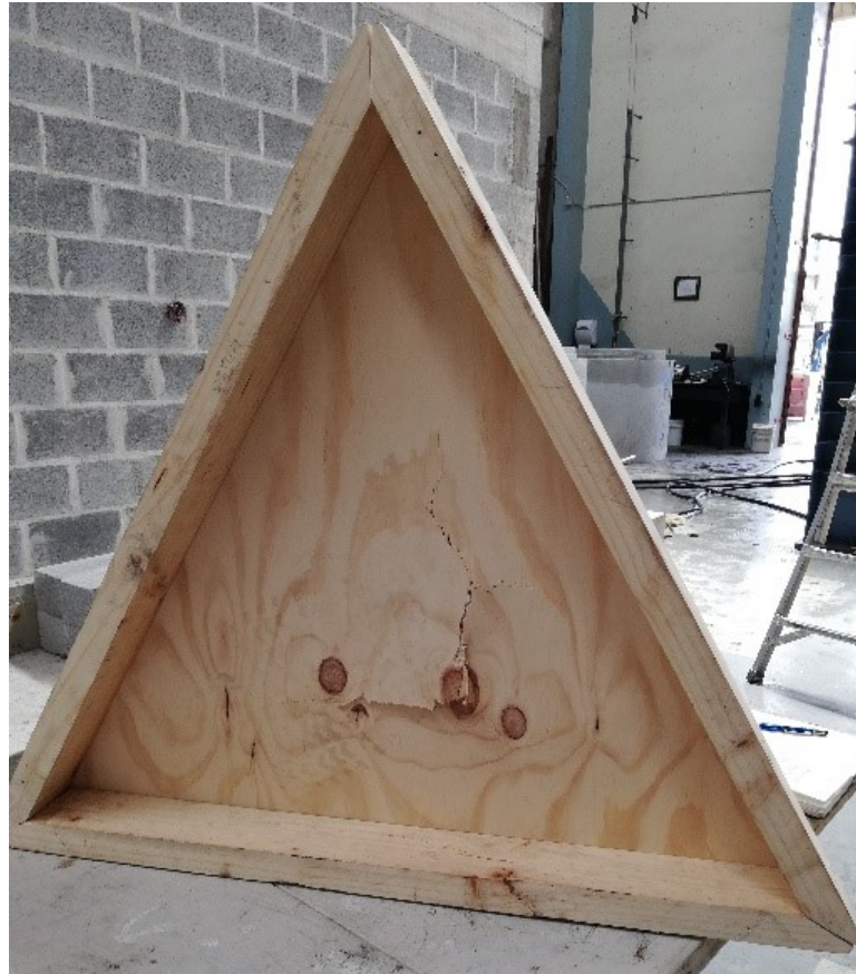
Figura 8.37. Imagen del estado del prototipo de piso al finalizar la simulación de carga. 336
