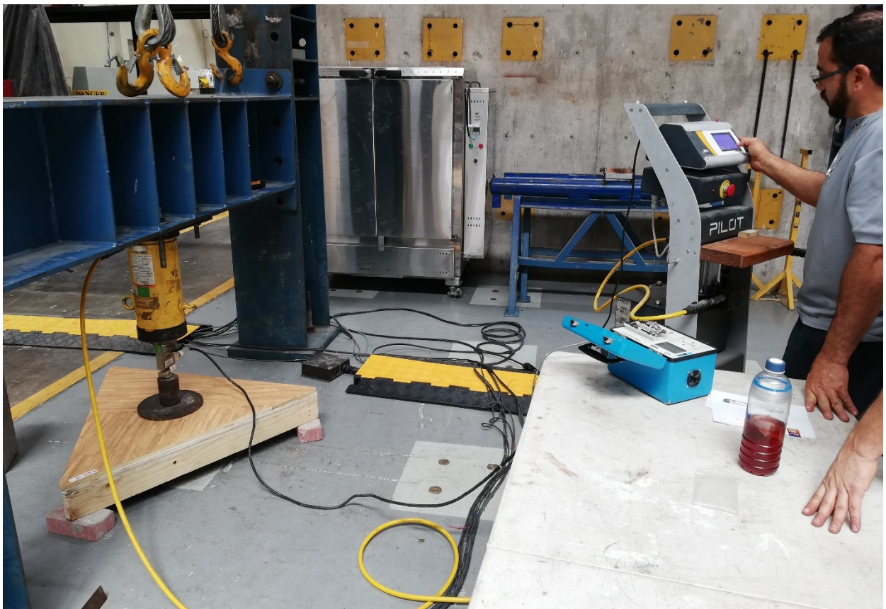
Figura 8.35. Vistas de la prueba de carga estructural al módulo de piso de la tipología B. 334
