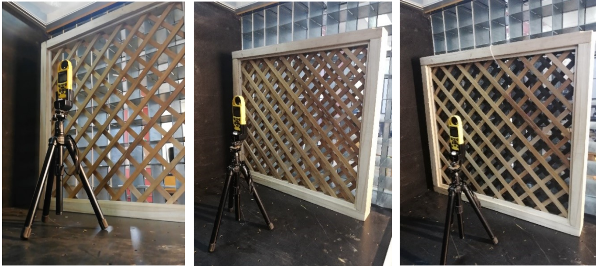
Figura 8.34. Vistas varias del túnel de viento del LAT en pruebas a versiones distintas del cerramiento del módulo B. 333
