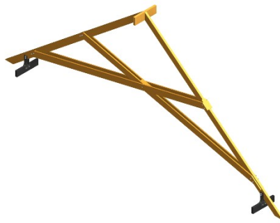
Figura 7.37. Isométrico de cercha típica de techo en madera. 243
