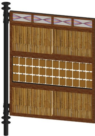
Figura 7.46. Vista isométrica del panel de cerramiento PA-02. 252
