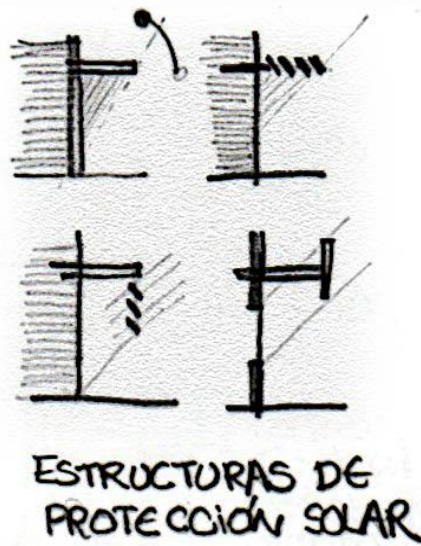
IMAGEN 3.13 Proyecciones horizontales y verticales para protección solar. Elaborado por Grettel Vargas , enero 2011
