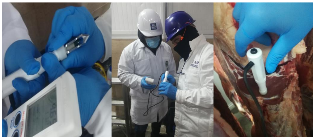
Figura 35. Punta de acero inoxidable, calibración y método de utilización del pH-metro para la medición de pH y temperatura a las 24 horas post mortem.
