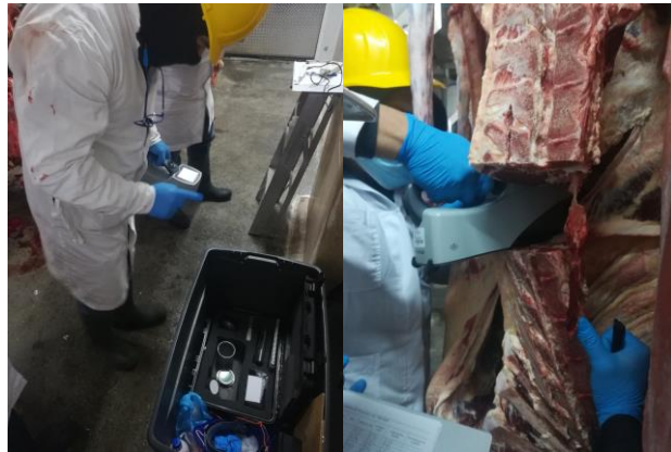
Figura 36. Calibración y uso del espectrofotómetro para determinar el color del músculo a las 24 horas post-mortem.
