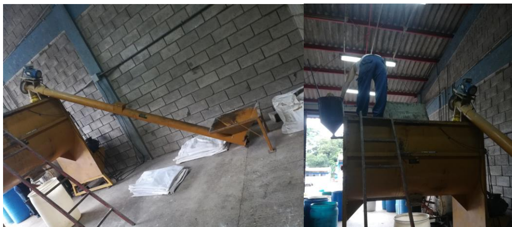
Figura 25. Mezcladora horizontal utilizada en la elaboración de los alimentos balanceados del grupo de novillos del proyecto.
