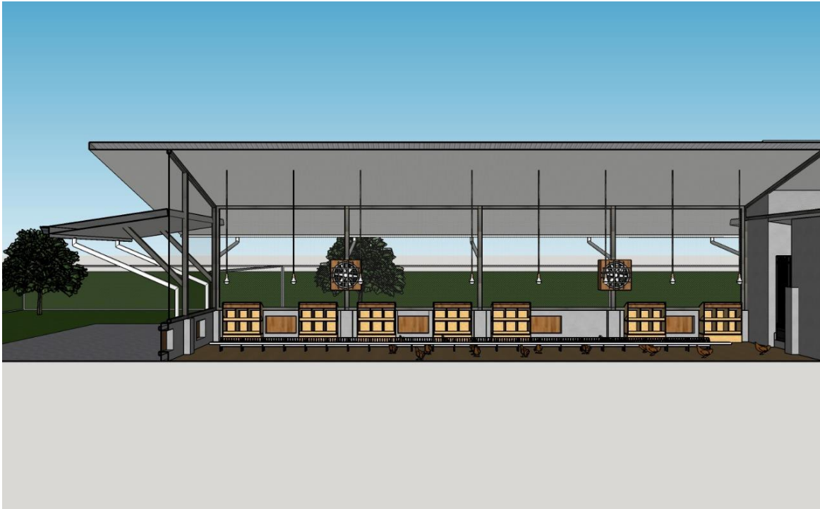
Figura 52. Corte longitudinal posterior de la galera para gallina ponedora con acceso a pastoreo.
