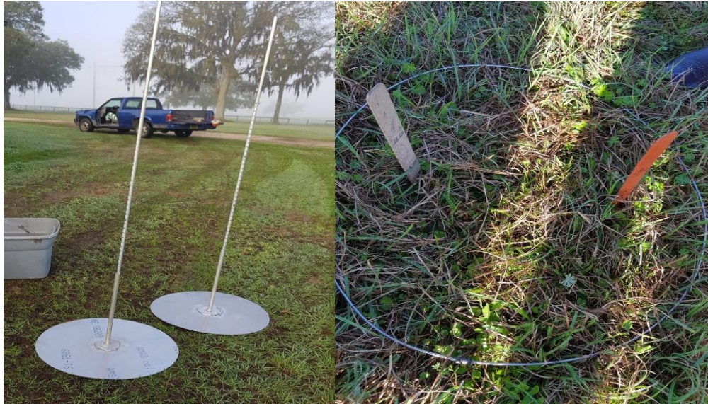
Figura 1. Plato medidor utilizado para medir la altura de los forrajes (Izquierda) y disco utilizado para marcar el forraje a recolectar (derecha).
