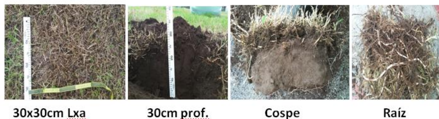
Figura 20. Imágenes de los pasos para realizar un análisis de compactación.
