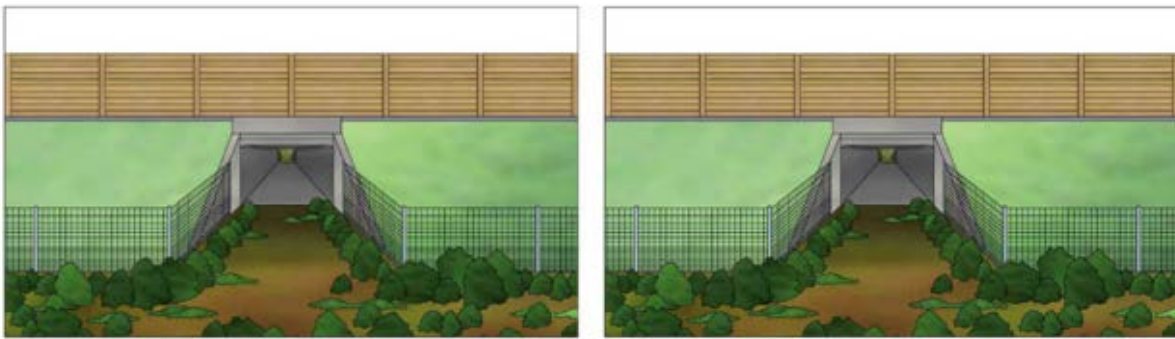
Figura 11. Esquema general para un paso inferior para mamíferos pequeños. Nota: Tomado de MAGRAMA, 2015
