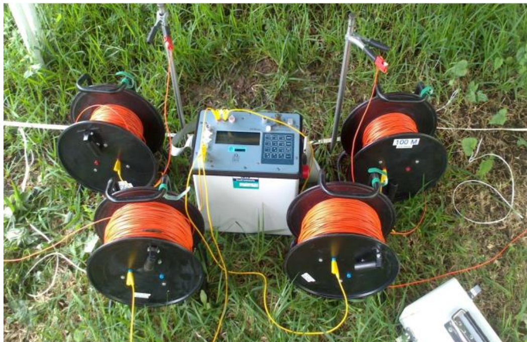
Figura 39. Equipo SYSCAL_R1/PLUS de la IRIS Instruments® utilizado en la prospección.
