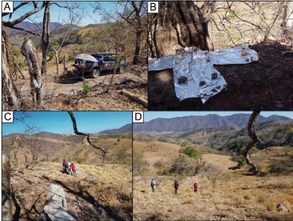
Figura 94. Generalidades del sitio en prospección. A) Estación TX-27 debidamente instalada para la prospección (El eje largo del carro indica el rumbo E-W de la antena); B) Detalle de instalación de los pines de la antena de la estación TX-27; C) y D) Lectura de los datos del perfil VLF-7 y visión general hacia el Norte del sitio de prospección (Se aprecia la cantidad de bloques sobre la superficie).
