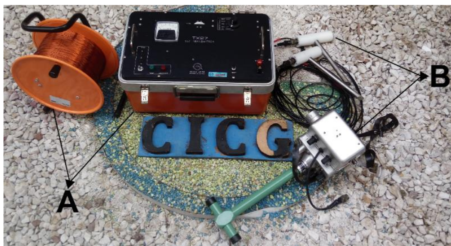
Figura 5. Equipo de prospección método VLF. A) Transmisor portable TX-27 y B) Receptor EM16/16R.
