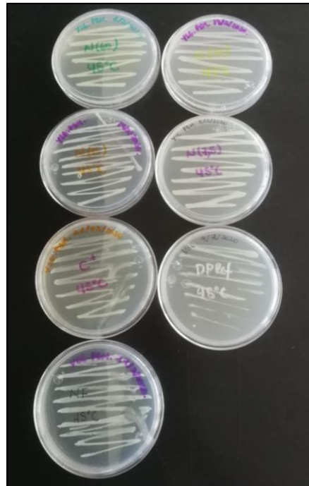
Figura 8. Ejemplo de placas luego de una prueba confirmatoria incubadas a 45 \pm 2 \text{ }^\circ\text{C} durante 18 – 20 horas.
