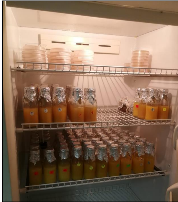
Figura 6. Incubadora a (45 \pm 2) °C con jugos para el análisis periódico a de A. acidoterrestris .
