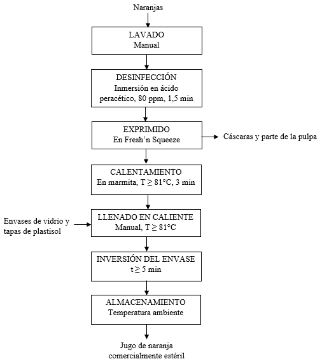
Figura 2. Flujo de proceso de elaboración de jugo de naranja estable a temperatura ambiente a partir de naranjas frescas.
