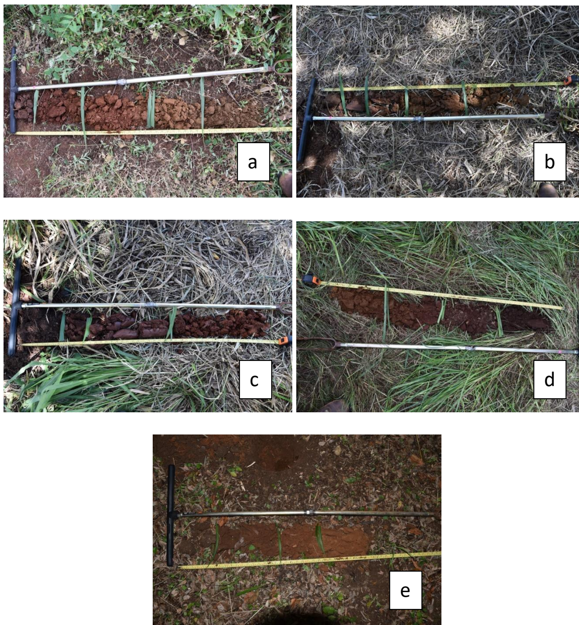
Figura 12. Descripción con barreno holandés del perfil del suelo en: a) Hoyo 3, b) Hoyo 7, c) Hoyo 10, d) Hoyo 11 y e) Hoyo 15.
