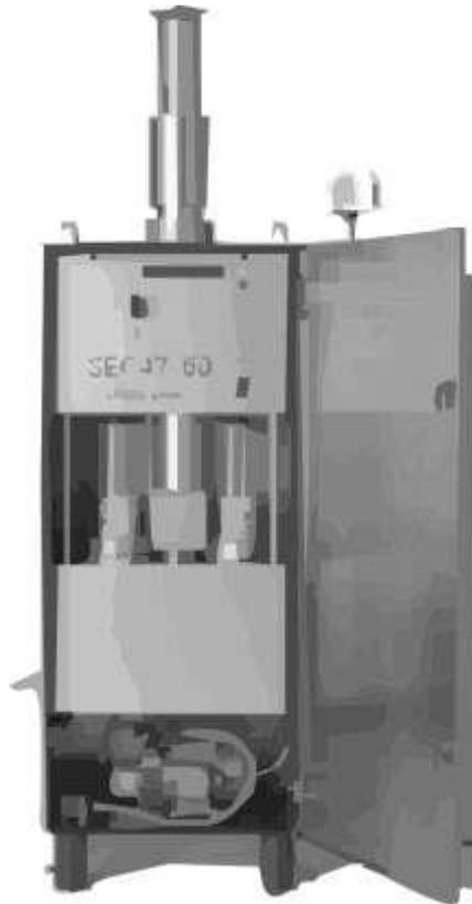
Figura 21. Dispositivo para medición de polvo de alto volumen (hi-vol.) Semiautomático
