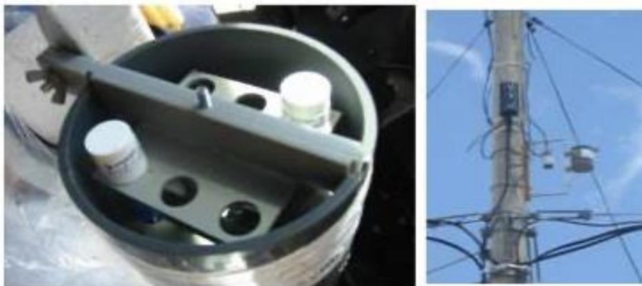
Figura 19. Dispositivo para medición de contaminante por deposición
