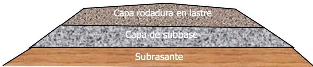
Figura 4. Perfil básico de una carretera no pavimentada
