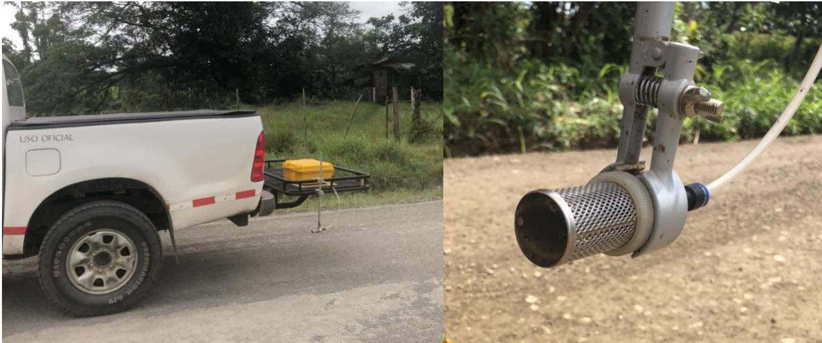
Figura 45. Boquilla de medición del dustmate
