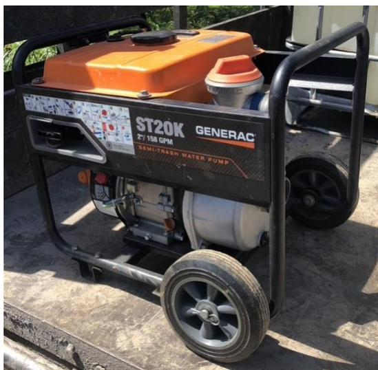
Figura 40. Bomba de gasolina de 2" / 158 gpm
