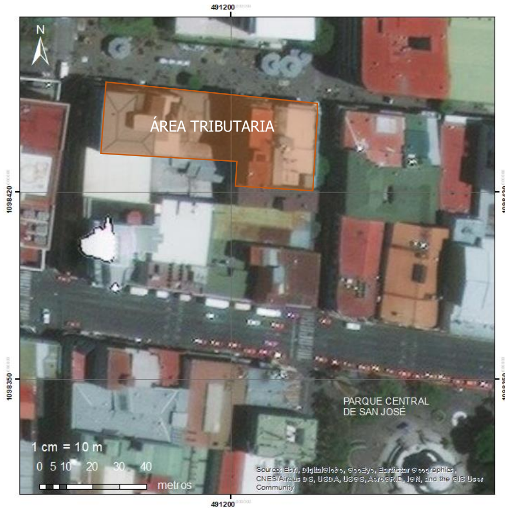
Figura 44. Áreas tributarias por tragante pluvial
