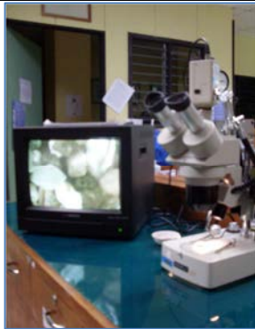
Fotografía 4: Microscopio, cámara y pantalla conectados
