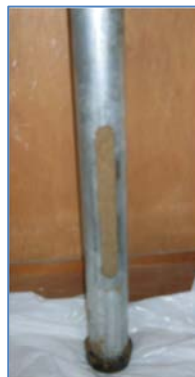
Fotografía 7: Tubo de 50 cm preparado para la medición de velocidad de infiltración.
