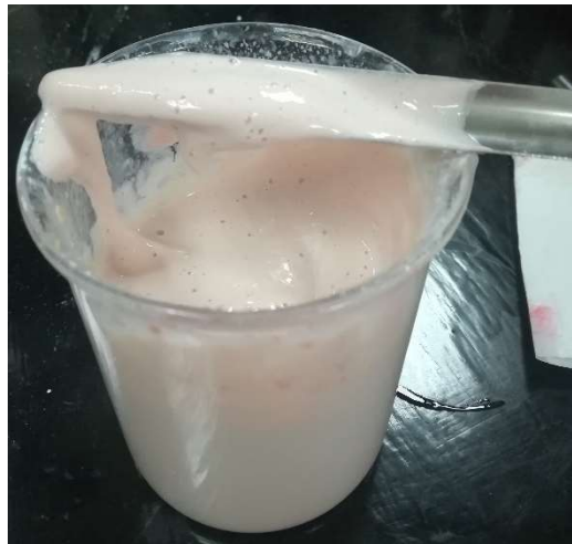
Figura 20: Comportamiento del producto luego de la adición del sulfato de neomicina siguiendo el proceso de fabricación habitual. Fuente: Elaboración propia.
