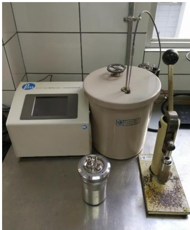
Figura 3.1 Equipo de bomba calorimétrica con termómetro digital de precisión y unidad de ignición Parr (Parr Instrument Company, 2013).
