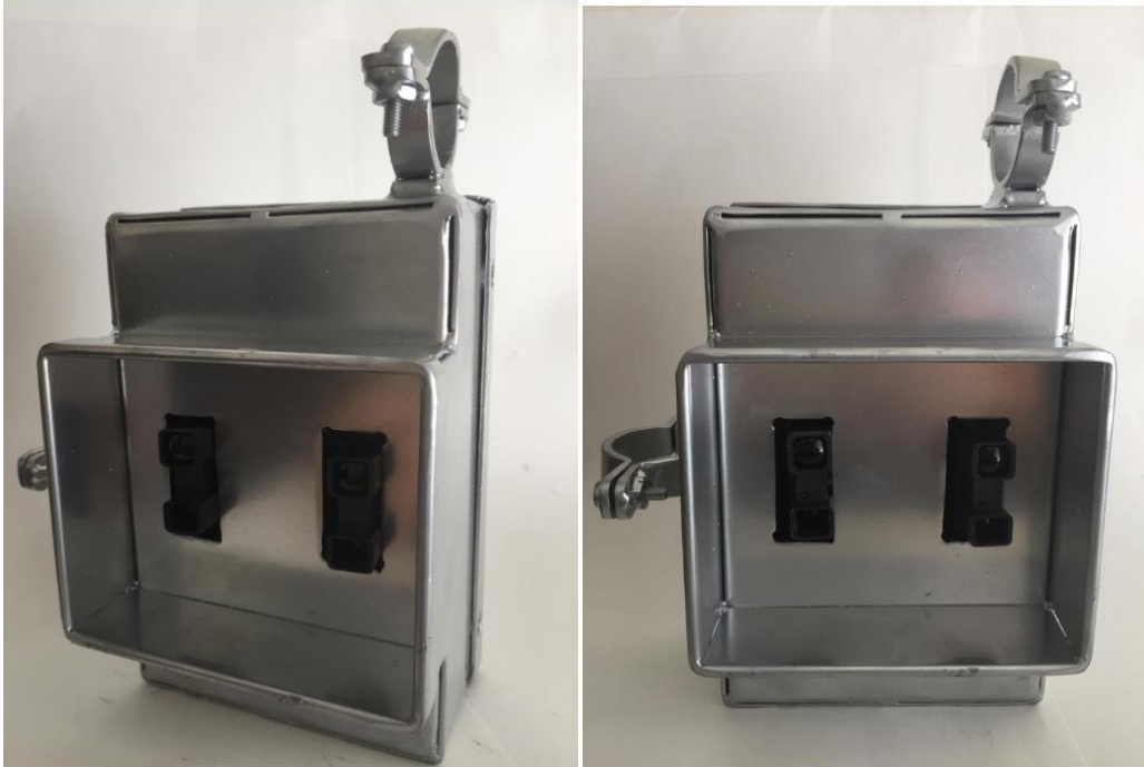
Figura 46. Diseño final del sistema automatizado para el conteo de pasajeros
