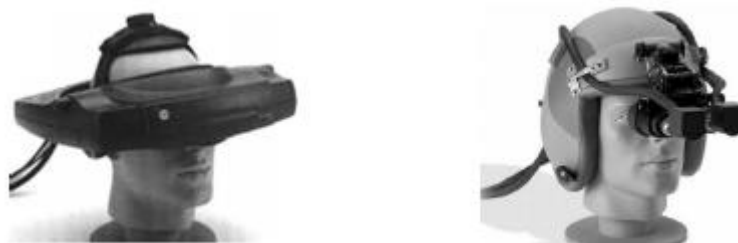
Figura 8. Ejemplo de HMD con tubos de rayos catódicos Fuente: Mejía, 2012.
