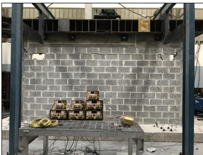
Figura 49. Condición final Muro RA.5.
