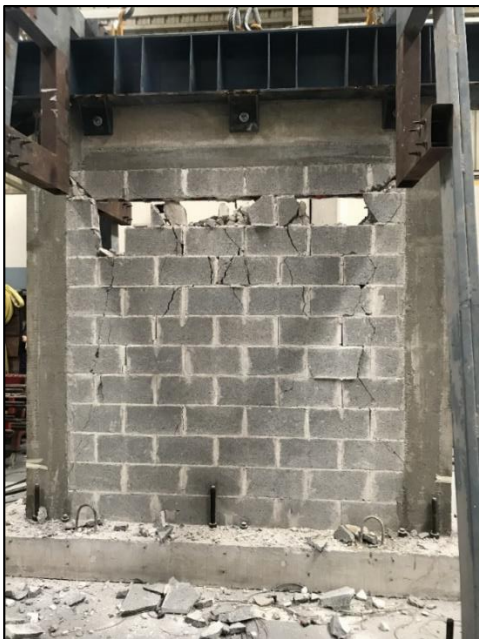
Figura 57. Estado final muro RA1.
