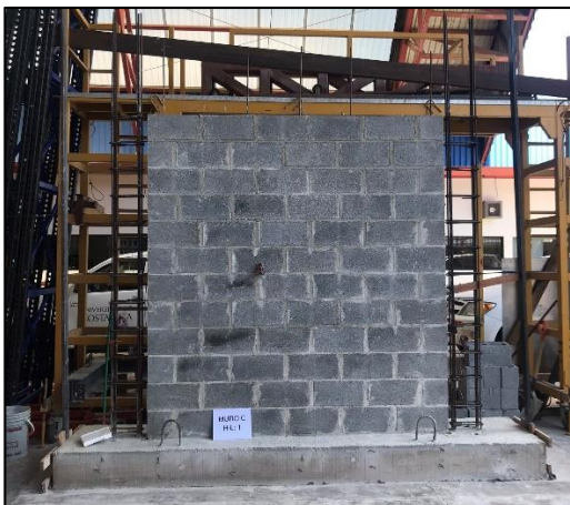
Figura 35. Paño de mampostería completado sin relleno.
