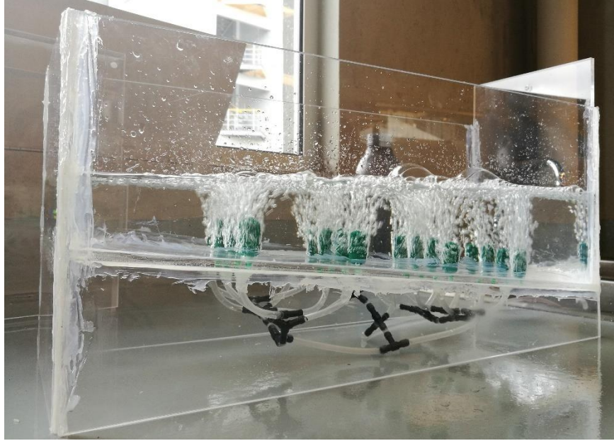
Figura 27. Tanque de aireación construido en el Taller de Biosistemas de la UCR
