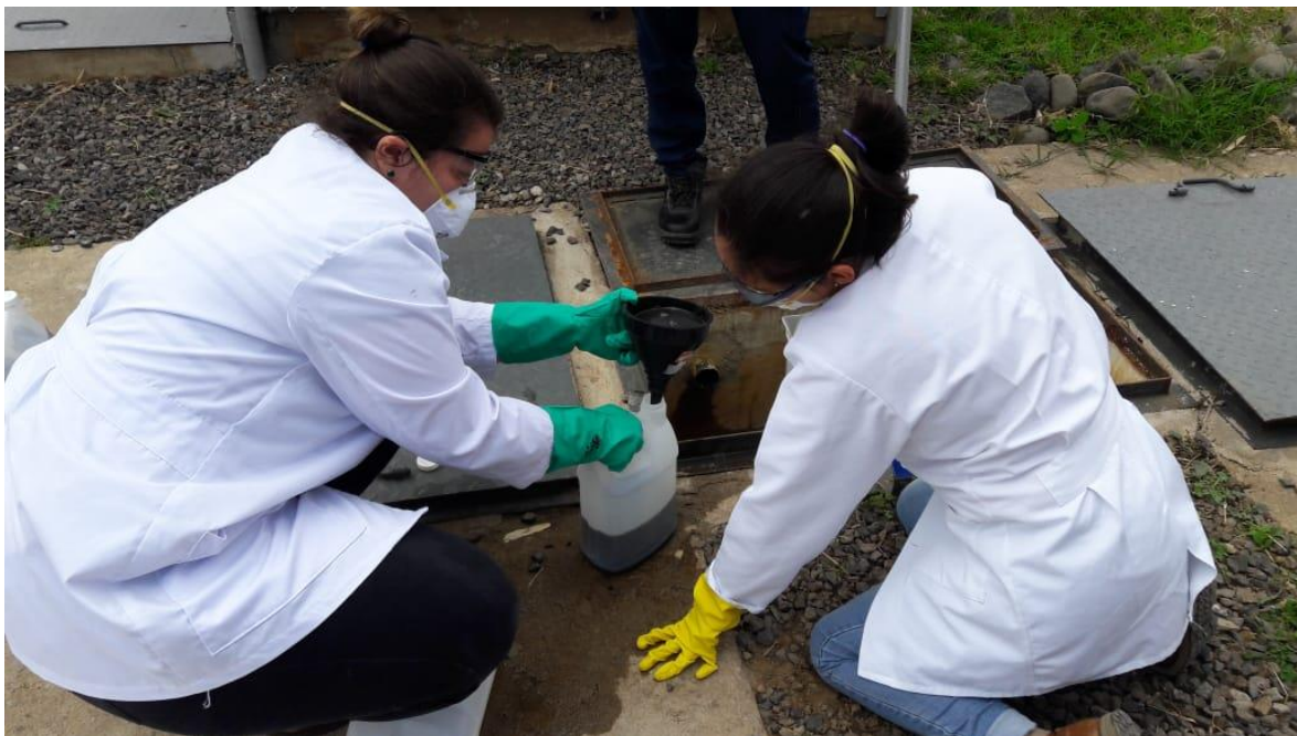
Figura 13. Recolección de agua residual en la PTAR de Odontología de la UCR
