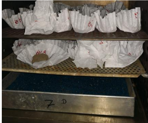
Figura 6. Muestras de suelo de FEIMA en el proceso de secado durante la determinación de la densidad aparente.
