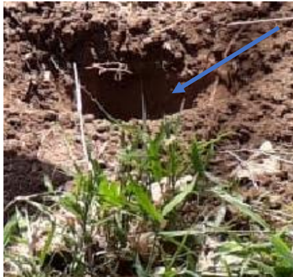
Figura 8. Agujero cilíndrico del modelo Porchet para medir la infiltración, implementado en FEIMA.
