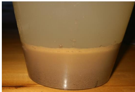
Figura 3. Deposición de sedimentos correspondientes a una muestra experimental durante la prueba de las clases texturales de los suelos de FEIMA.
