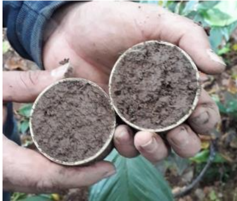
Figura 5. Extracción de suelo con el método de volumen conocido, para las pruebas de densidad aparente de las muestras de FEIMA.
