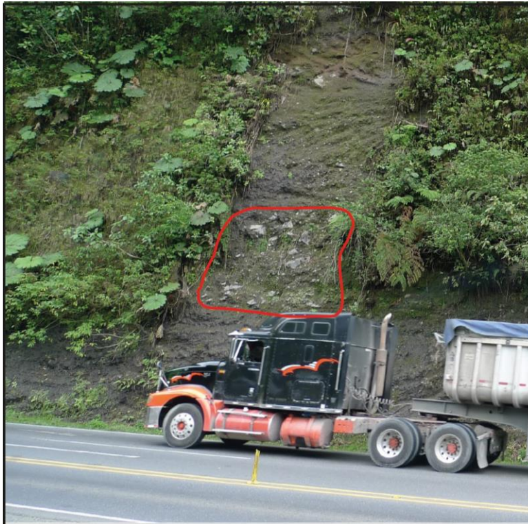
Figura 5.5: Estacionamiento 19+000, a aproximadamente 4 m de altura se observa un paquete de brechas con una mayor densidad de bloques que las unidades que lo rodean.
