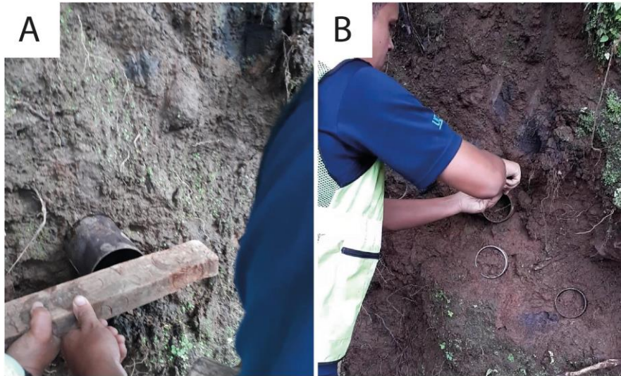
Figura 6.6: Proceso para extraer una muestra inalterada con poco espesor de suelo o en un suelo muy deleznable. A) se martilla el tubo dentro del suelo para crear un espécimen inalterado en el interior de este. B) muestra el proceso para extraer el tubo, el cual consiste en remover el suelo alrededor de este y así extraerlo sin mayor dificultad.
