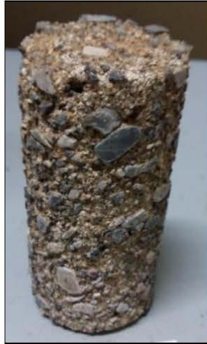
Figura 67. Muestra expuesta un flujo constante de disolución acida con pH 2, por un periodo de 11 semanas.
