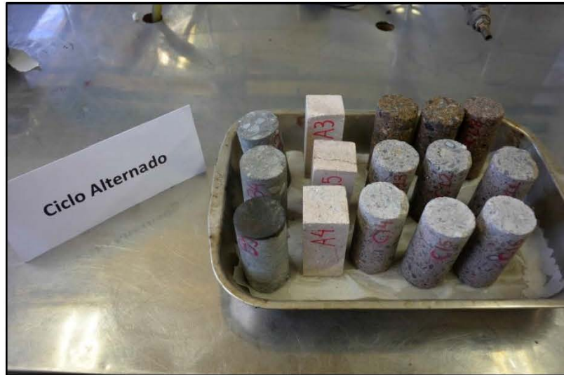
Figura 20. Muestras de concreto lanzado y roca, listas para ser introducidas al horno industrial.
