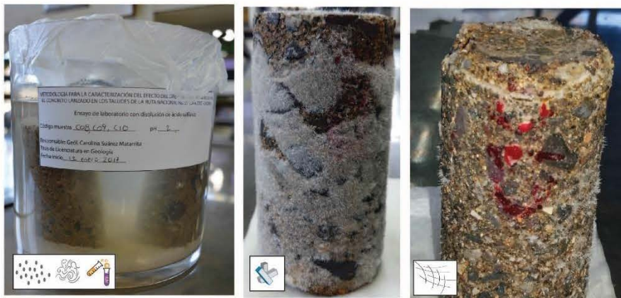
Figura 44. Cambios en el valor de pH 2 de la disolución en contacto con las muestras de concreto lanzado en el ensayo de Ciclo Alternado.
