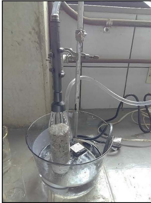
Figura 22. Ensayo de flujo de DAR. Bomba subacuática para simular la precipitación constante.
