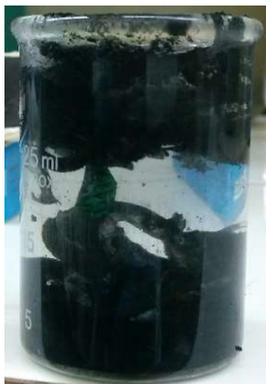
**Figura 3.1.** Muestra de baterías trituradas mezclada con agua.
