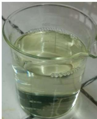
**Figura 3.2.** Filtrado de la disolución de las baterías.
