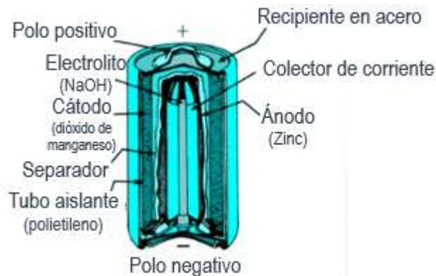
**Figura 1.3.** Composición interna de una batería de alcalina (Bocchi, Ferracin, & Biaggio, 2000).
