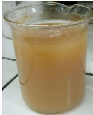
**Figura 3.3.** Disolución de los componentes internos de las baterías.
