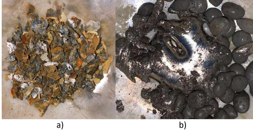
**Figura 3.26.** Resultado al fundir: a) una lámina de zinc de una batería agotada, b) zinc puro.
