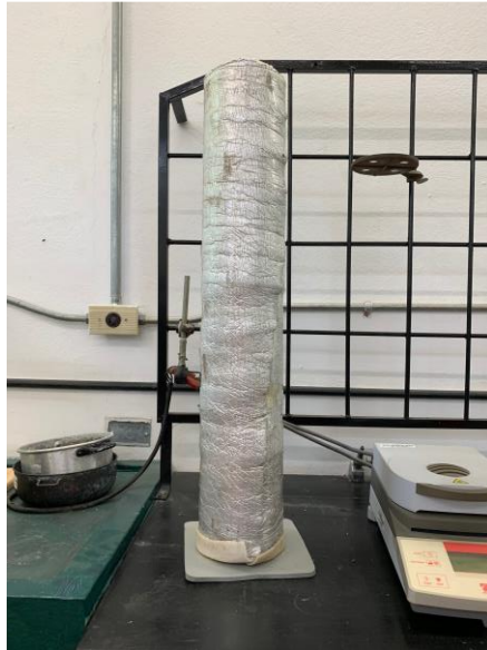
Figura 2.2. Equipo construido para la determinación de las propiedades térmicas de los fluidos de interés
