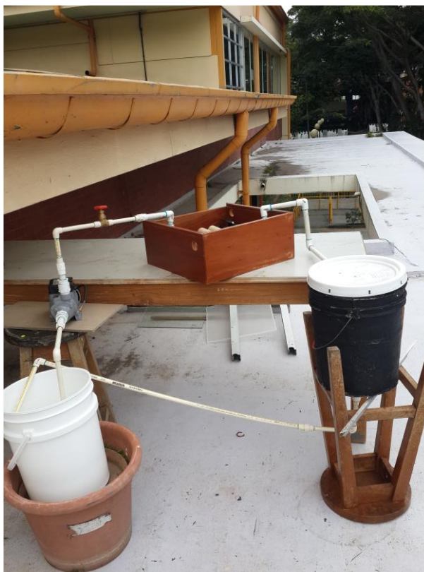
Figura 2.4. Prototipo construido del colector termosolar
