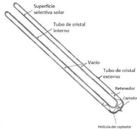
Figura 1.3. Colector de energía solar de vidrio al vacío de tipo mojado (Enteria & Akbarzadeh, 2014).
