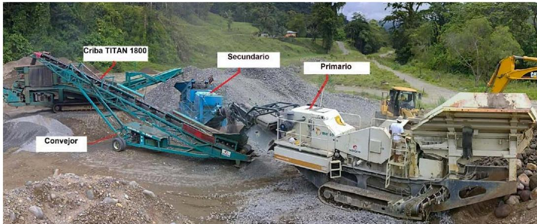
**Figura 2.1.** Distribución de planta de quebrado de agregado de "Las flores del Chirripó" (Araya, 2010).
