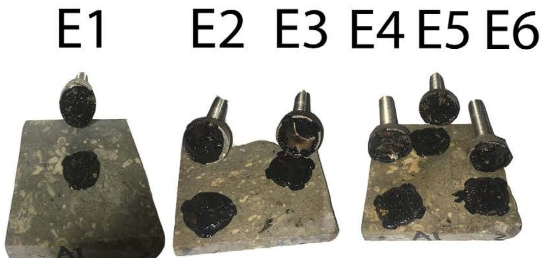
**Figura 6.52.** Resistencia a la adhesión por tracción uniaxial neumática de las muestras A1.
