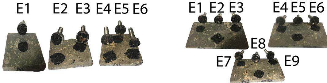
Figura 10.79. Fotografías del estado de falla de las muestras A1 y A2.
